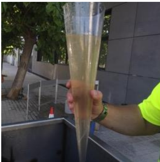
Durante el proceso de limpieza Air Scouring. (Sector Safranar)
